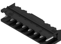
高耐熱性、90° 角度付き、開口オス型ヘッダー。箱詰め、ないしはテープの梱包。1.5 mm のソルダーピンを備えたテープ上で、自動機実装に最適化。リフローおよびフローはんだ付け適合3.2mmはんだピン。ピンヘッダは、マーキングスペースがあり、識別表示が可能です。HC = 高電流。
