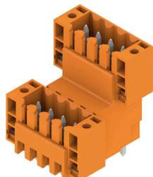
3.50mmピッチのフローはんだ対応2段型ピンヘッダです。サイドクローズ型とフランジ型があります。オス型コネクタは、マーキングスペースを提供し、コード化できます。
