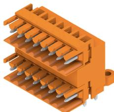
3.50mm ピッチのフローはんだ付け対応2段ピンヘッド。コネクタは、サイドオープン、サイドクローズ、フランジのバージョンで使用できます。オス型コネクタは、マーキングスペースがあり、識別表示が可能です。箱梱包。
