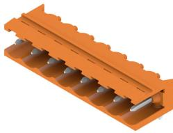
ガラスファイバー強化プラスチック製のピンヘッダで、電線出口が90°になっており、フローはんだ付けに最適です。フランジバリエーション (F) は、各カウンターパーツ(コネクタ)や回路基板にネジ止めすることができます。はんだフランジ (LF) バージョンを使用すれば基板への補助固定にネジ作業を必要としません。また、機械的な歪みからはんだ付け箇所を保護することもできます。すべてのピンヘッダは、マニュアルでコーディングすることも、コーディング済みのものをご注文いただくことも可能です。HC = 高電流。
