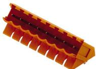
135 の取り出し方向オス型コネクタ。はんだピンの長さは、フローはんだ付けに適した長さになっています。ピンヘッドは、マーキングスペースがあり、識別表示が可能です。
