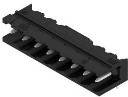
高耐熱性、90° 角度付き、開口オス型ヘッダー。箱詰め、ないしはテープの梱包。1.5 mm のソルダピンを備えたテープ上で、自動機実装に最適化。リフローおよびフローはんだ付け適合3.2mmはんだピン。ピンヘッダは、マーキングスペースがあり、識別表示が可能です。HC = 高電流。
