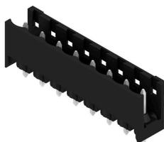
高耐熱性、直線、開いたピンヘッダー。箱もしくはテープ梱包。1.5 mm のソルダピンを備えたテープ上で、自動機実装に最適化。リフローおよびウェーブはんだ付け適合3.2 mm ソルダピン。ピンヘッダは、マーキングスペースがあり、識別表示が可能です。HC = 高電流。
