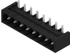
高耐熱性、直線、開いたピンヘッダー。箱もしくはテープ梱包。1.5 mm のソルダーピンを備えたテープ上で、自動機実装に最適化。リフローおよびウェーブはんだ付け適合3.2 mm ソルダーピン。ピンヘッダは、マーキングスペースがあり、識別表示が可能です。HC = 高電流。
