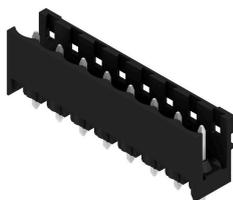
高耐熱性、直線、開いたピンヘッダー。箱もしくはテープ梱包。1.5 mm のソルダールピンを備えたテープ上で、自動機実装に最適化。リフローおよびウェーブはんだ付け適合3.2 mm ソルダールピン。ピンヘッダは、マーキングスペースがあり、識別表示が可能です。HC = 高電流。
