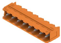
ガラスファイバー強化プラスチック製のピンヘッダーで、電線出口が90°になっており、フローはんだ付けに最適です。フランジバリエーション (F) は、各カウンターパーツ(コネクタ)や回路基板にネジ止めすることができます。はんだフランジ (LF) バージョンを使用すれば基板への補助固定にネジ作業を必要としません。また、機械的な歪みからはんだ付け箇所を保護することもできます。すべてのピンヘッダは、マニュアルでコーディングすることも、コーディング済みのもをご注文いただくことも可能です。HC = 高電流。
