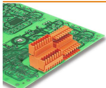
3.50mmピッチのフローはんだ対応2段型ピンヘッダです。サイドクローズ型とフランジ型があります。オス型コネクタは、マーキングスペースを提供し、コード化できます。
