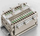
マーカーホルダーは、5 または 5.1 mm ピッチの標準マーカーを追加で取り付けることができます。斜め型ホルダーはオプションで一緒にスナップ可能で、Klippon® コネクトモジューラー端子台のすべての標準マーキングチャネルに設置できます。対応マーカーの種別は、指定印字ホルダーの各アクセサリの下で確認できます。
