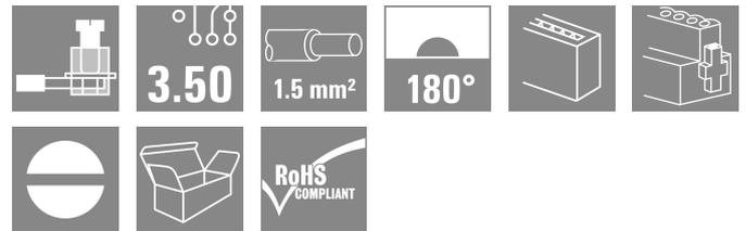
3.50mmピッチの電線接続用クランピングヨークねじ接続方式のメス型コネクタです。ピンヘッダーはマーキングスペースがありコード化することが可能です。
