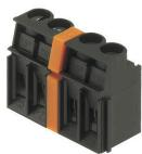
最大電圧は最小距離を基に決まります。中間プレートにより、電位の異なる場所間の沿面距離と空間距離が増加し、主電圧と低電圧、または異なる保護ゾーン間などの高定格電圧または明確な絶縁が可能になります。
