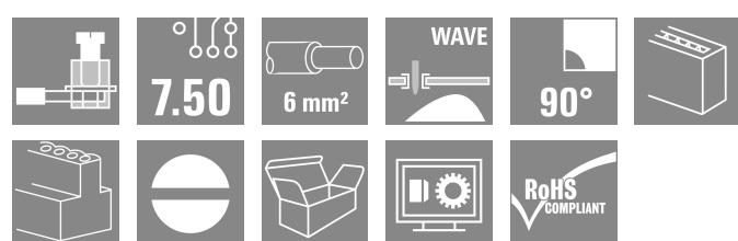
この PCB 端子は、1000 V、導体直径 6 mm、32 A に対応し、7.50 および 7.62 mm ピッチ、導体取り出し方向 90 および 180 形状で実績豊富なクランピングヨーク接続を提供します。
