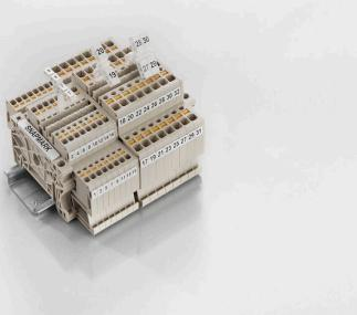
SnapMark - このタグキャリアは、I モデルシリーズの二段端子 IDK 1.5N に対応して特別に開発されています。柔軟なピボット機構は、渡り配線の容易な取り付け、取り外しを可能にします。4 種の DEK 5 ラベリングタグ、または 2 種の WS 10/5 Middle コネクタマーカーを保持できます。
