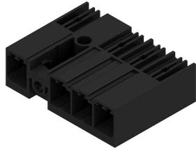
7.62 ピッチのミドルフランジ付属 90° オス型ヘッダー。IEC 61800-5-1 の要件を満たし、UL840 600 V に準拠した UL 認証を取得します。メス側ヘッダーなしの場合、接合プロファイルにより、テストフィンガーに 20 N の圧力をかけた状態で 3 mm を超える接触安全性が保証されます。オプションでネジ固定も可能なミドルフランジのセルフロックにより、従来のソリューションと比較して、必要なスペースを 1 ピッチ幅に削減できます。ご要望に応じて、ネジフランジ付き、またはフランジなしでご利用になれます。
