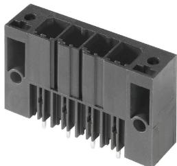
電極を犠牲にすることなく、またはツールを使わずに高速に整列状態で固定できる特許取得済みのフランジを備えた、単列で高性能なオス型ヘッダー。接合プロファイルにより、固有に識別可能なコーディング多様性およびフランジへの追加締め付けにより、誤接を防止し、接続性と動作信頼性が最大限に向上します。3.5 mm のピン長は、鉛フリーのウェーブはんだ付けに最適化されています。
