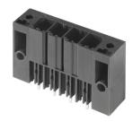
電極を犠牲にすることなく、またはツールを使わずに高速に整列状態で固定できる特許取得済みのフランジを備えた、単列で高性能なオス型ヘッダー。接合プロファイルにより、固有に識別可能なコーディング多様性およびフランジへの追加締め付けにより、誤接を防止し、接続性と動作信頼性が最大限に向上します。3.5 mm のピン長は、鉛フリーのウェーブはんだ付けに最適化されています。
