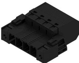
180° 反転ピンヘッダー。7.62 ピッチで 6 mm<sup>2</sup> のワールド配線対応ブッシュイン接続技術採用。エンクロージャーフィードスルー対応の「3 フランジバリエーション」。最大壁厚 2 mm のエンクロージャーに適合。逆電圧に対するタッチセーフソリューションとしても最適です。UL1059 600 V クラス C および IEC 61800-5-1 の要件を満たします。
