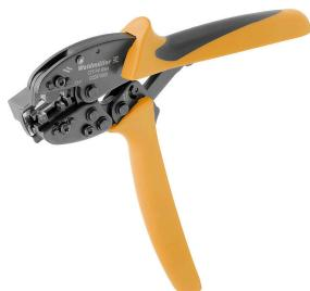
絶縁材を剥ぎ取った後、ケーブル端部に最適な接点またはフェルール端子をクリンプできます。クリンプは、導体と接点との間に安全な接続を形成し、今では概ねはんだ付けに取って代わっています。クリンプは、導体と接続エレメントの間に均一で永続的な接続作成を示します。高品質の精密ツールを使わなければ、その接続を作成できません。その結果、機械的、電気的な両方の条件で安全で信頼性の高い接続が得られます。ワイドミュラーは、さまざまな機械クリンプツールを提供しています。リリース機構搭載の統合ラチケットは、最適なクリンプを保証します。ワイドミュラーの工具で作られたクリンプ接続は、国際規格や規制に準拠しています。
