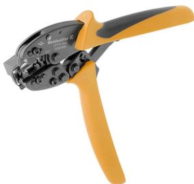
絶縁材を剥ぎ取った後、ケーブル端部に最適な接点またはフェール端子をクリンプできます。クリンプは、導体と接点との間に安全な接続を形成し、今では概ねはんだ付けに取って代わっています。クリンプは、導体と接続エレメントの間に均一で永続的な接続作成を示します。高品質の精密ツールを使わなければ、その接続を作成できません。その結果、機械的、電気的な両方の条件で安全で信頼性の高い接続が得られます。ワイドミュラーは、さまざまな機械クリンプツールを提供しています。リリース機構搭載の統合ラチェットは、最適なクリンプを保証します。ワイドミュラーの工具で作られたクリンプ接続は、国際規格や規制に準拠しています。
