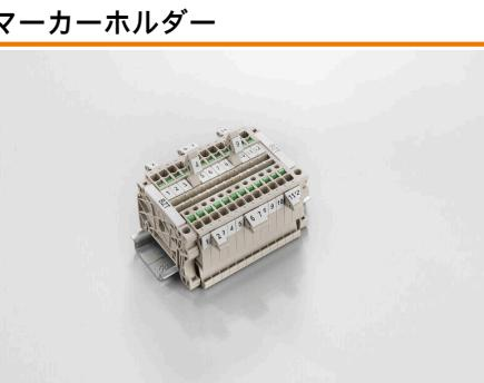
マーカーホルダーは、5 または 5.1 mm ピッチの標準マーカーを追加で取り付けることができます。斜め型ホルダーはオプションで一緒にスナップ可能で、Klippon®コネクトモジューラー端子台のすべての標準マーキングチャネルに設置できます。対応マーカーの種別は、指定印字ホルダーの各アクセサリの下で確認できます。
