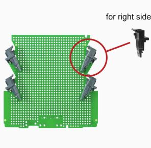
ウェーブはんだ付け対応で、ソルダーピン長が最適化されたオス型コネクタ。ピンヘッダは、マーキングスペースがあり、識別表示が可能です。
