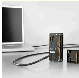
完全封入の WCU 501 および WCU 650 ロジックモジュールを使用すると、過度の環境条件下でも、プロセスモニタリング、制御、および調整が行えます。この点で、WCU シリーズは最適な寸法、性能、堅 固性、使いやすさを提供します。グラフィックと直感的な Micon-L プログラミング環境により、アナログ入力およびデジタル入力の柔軟な切り替えやデジタル出力も可能になります。お客様の要求に応じて、ソフトウェアおよびハードウェアの両方の範囲を拡張できます。.
