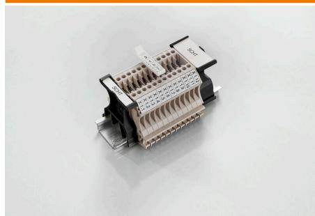
CHT 5 S グループタグキャリアは、TS 32 取り付けレール (G レール) または TS 35 取付レール (トップハットレール) に直接クリップ固定されています。したがって、端子とその種別に関係なく、端子ストリップにラベリングを実施できます。SchT 5 と SchT 5S には、ESO 5、STR 5 保護ストリップが取り付けられています。SchT 7 は、クランプネジに容易にアクセス可能な差し込み板対応のヒンジ付属グループタグキャリアです。SchT 7 には、ESO 7、STR 7 の保護ストリップまたは DEK 5 が取り付けられています。差し込み板および保護ストリップは、「アクセサリ」の下にあります。
