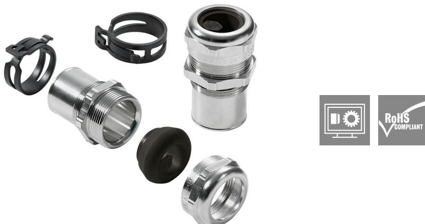
電子部品の感度の向上と電磁干渉周波数の増加により、ケーブルグランドはシステムの外装コンセプトにおいて重要な役割を果たす必要があります。この種別の EMC ケーブルグランドは、360 のスクリーニング接続で、干渉周波数に対する遮蔽を目的に作成されています。フィンガーロックシールは、優れたケーブル保持とケーブル負荷解放部品を提供し、ケーブルグランドは EN 62444 の機械的要件に準拠します。特許取得済形状により、非常に簡単で高速な組み立てが可能になります。
