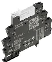
追加機能搭載の制御信号適応対応のタイミングリレー。タイミングリレーは、制御システムやその他装置における高速スイッチングプロセスの調整に使用されます。TERMSERIES TIMER タイミングリレーにはオンディレイがあり、機械のスイッチオンの遅延、システムコンポーネントのカスケード起動、あるいはポンプやバルブなどのユーザー機器の遅延起動を可能にします。それらはまた、One Shot および方向指示機能も備えています。コンパクトな 6.4 mm 端子台形式のTERMSERIES TIMER タイミングリレーは、ネジ接続またはプッシュイン導体接続で使用できます。側面のDIPスイッチを介してタイミング機能と時間範囲を便利に調整することができます。イジェクトレバー上の見やすいデュオ LED により、電源電圧供給と各切り替え状態を一目で確認できます。EN 61812に従った国際認可により、世界中のどこでも使用することができます。TERMSERIES TIMER が幅広い TERMSERIES アクセサリと互換性があることにより、高い柔軟性と既存システムへの容易な統合を実現します。
