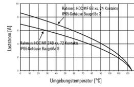
HDC-MHD 12-Module im IP65-Gehäuse,
