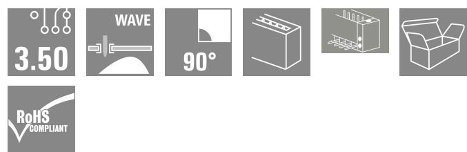
3.50 mm ピッチのウェーブはんだ付け対応ピンヘッダー
