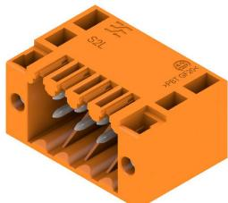
アングル型2段ピンヘッダーは、サイドクローズ型とフランジ付きがあります3.2mmのはんだピン長は、フローはんだ付けに適しています。プリント基板にねじ止め固定されます。ピンヘッダは、マーキングスペースを提供し、コード化できます。
