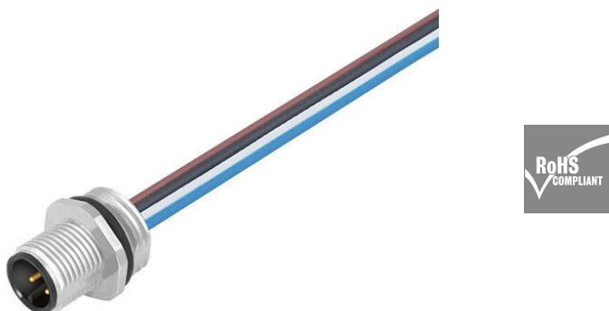
周辺デバイスには、より大きな電力を供給する必要があります。新型 M12 プラグインコネクタを使用すれば、250 V および 2 A 以上を問題なく取り扱えます。小型の A、K、L、S および T コードの M12 プラグインコネクタは、最大 630 V AC または 60 V DC および 12 A の伝送に設計されています。
