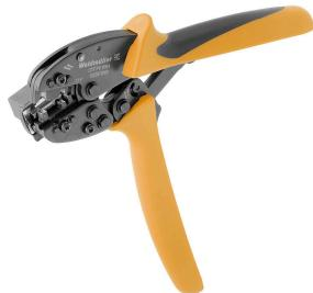
絶縁材を剥ぎ取った後、ケーブル端部に最適な接点またはフェルール端子をクリンプできます。クリンプは、導体と接点との間に安全な接続を形成し、今では概ねはんだ付けに取って代わっています。クリンプは、導体と接続エレメントの間に均一で永続的な接続作成を示します。高品質の精密ツールを使わなければ、その接続を作成できません。その結果、機械的、電気的な両方の条件で安全で信頼性の高い接続が得られます。ワイドミュラーは、さまざまな機械クリンプツールを提供しています。リリース機構搭載の統合ラチエットは、最適なクリンプを保証します。ワイドミュラーの工具で作られたクリンプ接続は、国際規格や規制に準拠しています。
