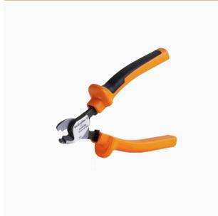
最大外径 8 mm、12 mm、14 mm、22 mm の導体対応カットツール。特殊形状の刃を使用すると、銅およびアルミニウム製の導体を、最小限の物理的な労力とピンチ不使用で切断できます。また切断工具(KT 8 ~ KT 22)には、EN/IEC 60900 に準拠した最大 1,000 V までの VDE および GS でテスト済みの保護絶縁材も付属します。
