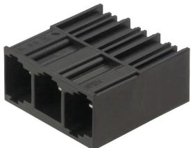
単列、高電流オス型ヘッダーは電極を犠牲にすることなく整列状態に取り付けることができます。また、ツール不使用ですばやくロックするための特許取得済みのフランジが付属します。接合プロファイルにより、固有に識別可能なコーディング多様性およびフランジへの追加締め付けにより、誤接を防止し、接続性と動作信頼性が最大限に向上します。3.5mm 長のピンは、フローはんだ付けに対して最適化され、プラグイン方向は、はんだ付けピンに対して 90° です。
