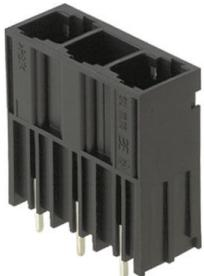
単列大電流オス型ヘッダ、極数を損なうことなくサイドバイサイド実装が可能、また、特許取得のフランジにより工具なしで素早いロックが可能です。誤接続を防ぐ嵌合構造、独自の多様なコーディング、追加固定、および一体型位置決め補助により、最大の接続性と動作信頼性を実現。3.5 mm ピン長はフローはんだ付けに最適化されており、接続方向は、はんだピンに対して180°です。
