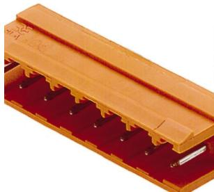
プラグ固定範囲からの寸法安定、角度付き、コード化可能なオス型コネクタで、誤接を防止するために統合型の補助装置を備えています。開いた側面または閉鎖状態の側面で使用できます。固定ブロックは、溝付きサイドクローズバージョンに取り付けできます。3.2mmのはんだピン長は、フローはんだ付けに適しています。ポール紙製の箱で提供されます。
