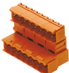
端子台レール用のマウンティングフットは、基板、筐体、制御盤にプラグイン式の接続システムを幅広く使用でき、配線作業が容易になります。サイドクローズタイプとサイドオープンタイプが利用可能。固定ブロックは、溝付きサイドクローズバージョンに取り付けできます。3.2mmのはんだピン長は、フローはんだ付けに適しています。ポール紙製の箱で提供されます。
