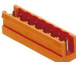
ユニメートシリーズは、優れた寸法安定性、電線接続方向がストレート、広いマーキングスペース、誤接続防止勘合面が特徴のオス型コネクタです。サイドクローズタイプとサイドオープンタイプが利用可能。固定ブロックは、溝付きサイドクローズバージョンに取り付けできます。3.2mmのはんだピン長は、フローはんだ付けに適しています。ポール紙製の箱で提供されます。
