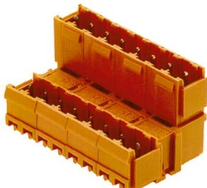
プラグ固定範囲からの寸法安定、直線、コード化可能な二層オス型コネクタで、誤接を防止するために統合型の補助装置を備えています。サイドオープンと溝付きサイドクローズの2種類を用意。固定ブロックは、溝付きサイドクローズバージョンに取り付けできます。3.2mmのはんだピン長は、フローはんだ付けに適しています。段ボール箱に梱包されて配送されます。
