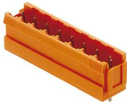
ユニメートシリーズは、優れた寸法安定性、電線接続方向がストレート、広いマーキングスペース、誤接続防止勘合面が特徴のオス型コネクタです。サイドクローズタイプとサイドオープンタイプが利用可能。固定ブロックは、溝付きサイドクローズバージョンに取り付けできます。3.2mmのはんだピン長は、フローはんだ付けに適しています。ボール紙製の箱で提供されます。
