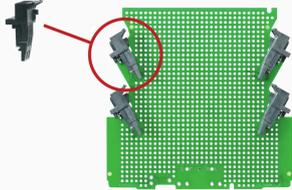
ウェーブはんだ付け対応で、ソルダーピン長が最適化されたオス型コネクタ。ピンヘッドは、マーキングスペースがあり、識別表示が可能です。
