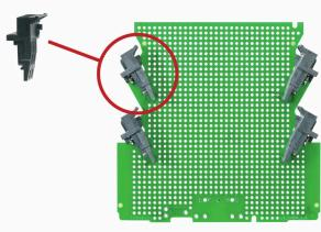
ウェーブはんだ付け対応で、ソルダーピン長が最適化されたオス型コネクタ。ピンヘッダは、マーキングスペースがあり、識別表示が可能です。
