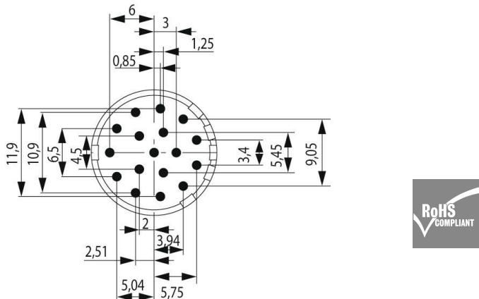
M23 丸型プラグインコネクタは、多数の接合サイクル、高い電流容量、および最小寸法での高い接触密度を提供します。
