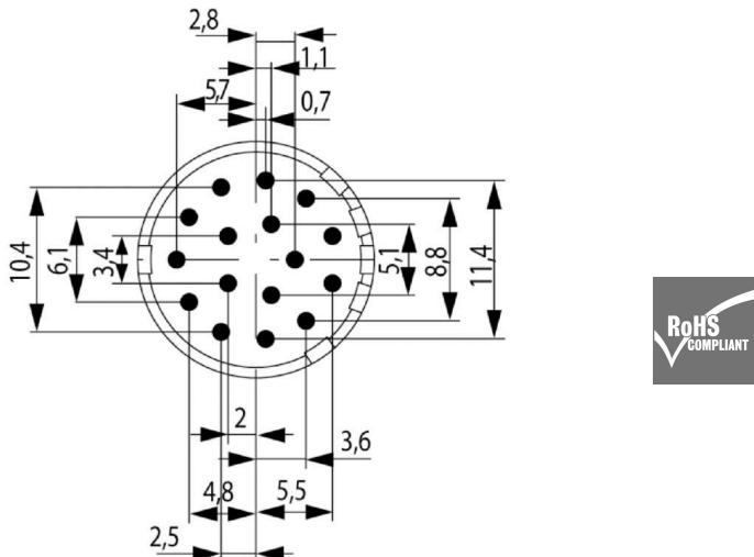
M23 丸型プラグインコネクタは、多数の接合サイクル、高い電流容量、および最小寸法での高い接触密度を提供します。
