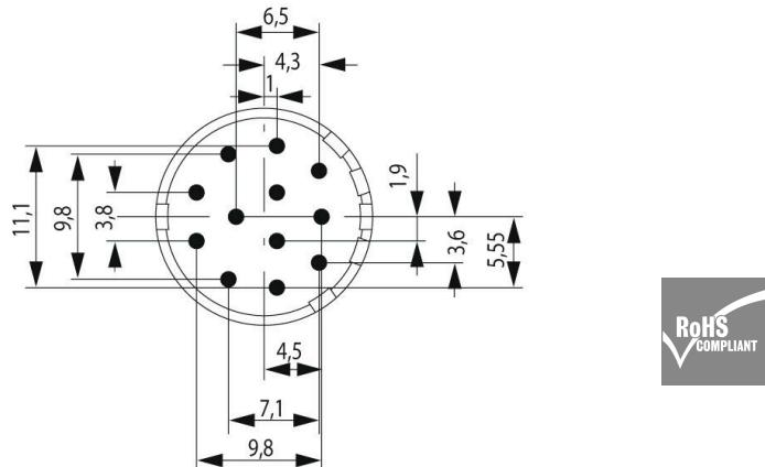
M23 丸型プラグインコネクタは、多数の接合サイクル、高い電流容量、および最小寸法での高い接触密度を提供します。
