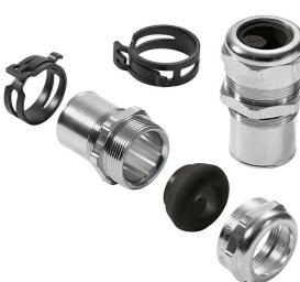
電子部品の感度の向上と電磁干渉周波数の増加により、ケーブルグランドはシステムの外装コンセプトにおいて重要な役割を果たす必要があります。この種別のEMCケーブルグランドは、360°のスクリーニング接続で、干渉周波数に対する遮蔽を目的に作成されています。フィンガーロックシールは、優れたケーブル保持とケーブル負荷解放部品を提供し、ケーブルグランドはEN 62444の機械的要件に準拠します。特許取得済形状により、非常に簡単で高速な組み立てが可能になります。
