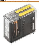
強制誘導接点搭載リレーモジュール 強制誘導接点を搭載するリレーは、99 % の診断範囲を 有し、安全システムでの使用で高く評価されています。 接点は互いに機械的に連結され、両方の接点の同期切り 替え状態が確保されます。これにより、エラーが発生し た場合 (例えば、過負荷による動作接点溶解の場合) に も、アラート接点の同じ切り替え状態の維持が保証され ます。コントローラ (または安全コントローラ) は、ア ラート接点を検出し、設定値と実際値を比較します。そ して、もし異変が生じれば、装置や人間の命を守る対策 を講じることができます。
