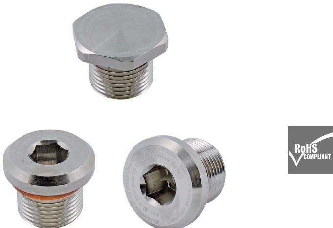
VP モデルシリーズのストッププラグは、安全増防爆 (Ex d) および安全増防爆 (Ex e) 規格、および IP66/67/68 の侵入率を有し、防爆機器での未使用入力を埋める方法を提供します。
