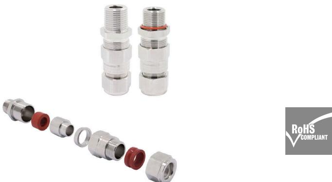
E1W 種別のケーブルグランドは、SWA 鋼線で配線された被覆ケーブルに適しており、E1W 種別のグランドは安全増防爆 (Ex d) および安全増防爆 (Ex e) 規格を有します。また、外装クランプにより、ケーブル外装とグランド間に電気接続が行われます。
