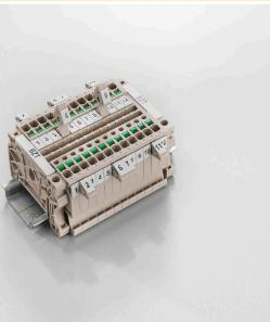
マーカーホルダーは、5 または 5.1 mm ピッチの標準マーカーを追加で取り付けることができます。斜め型ホルダーはオプションで一緒にスナップ可能で、Klippon® コネクトモジューラー端子台のすべての標準マーキングチャネルに設置できます。対応マーカーの種別は、指定印字ホルダーの各アクセサリの下で確認できます。
