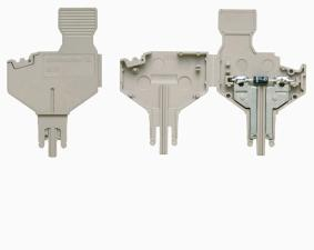
コンポーネントプラグは、電子コンポーネントを接続断路端子台に統合するために使用されます。電子コンポーネントのはんだ付け後、プラグを接続断路端子台の断路箇所に組み込むことで、断路端子台を電子コンポーネント内蔵型のモジューラー端子台に変更します。
