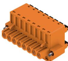
高性能バスアプリケーション用の強力なデイジーチェーンソリューションは、18.5Aの電流容量で400Vの補助電源供給にも適しています。大きなクランプ容量(最大 2.5 mm の導体断面積)は、低電圧降下のため、長いバスケーブルや高電流に特に有効です。
