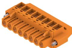
直角 (90° または 270°) の電線接続方向対応のクランプヨークねじ接続タイプのメス型プラグ。メス型コネクタは、マーキングスペースを提供し、コード化できます。フランジまたはリリースラッチによって固定。また、プラス/マイナスネジを搭載し、電線の誤挿入防止構造を備えたクランプヨークは、すぐに電線が接続できるようクランプが開いた状態でお届けします。HC = 高電流。
