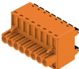
高性能バスアプリケーション用の強力なディジーチェンソリューションは、18.5Aの電流容量で400Vの補助電源供給にも適しています。大きなクランプ容量(最大 2.5 mm の導体断面積)は、低電圧降下のため、長いバスケーブルや高電流に特に有効です。
