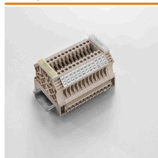
EM 8/30 エンドブラケット用マーカーは、WEWW 35/2 および ZEW 35/2 エンドブラケットのラベリングに適し、また、W モデルシリーズ端子のグループタグキャリアとしても使用できます。EM 8/30は、ESO 7/ESO 7P の差し込み板を保持できます。ポケットは、環境への影響から印刷を確実に保護します。差し込み板は、「アクセサリ」の下にあります。
