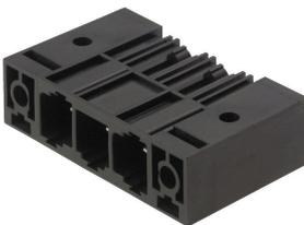
電極を犠牲にすることなく、またはツールを使わずに高速に整列状態で固定できる特許取得済みのフランジを備えた、単列で高性能なオス型ヘッダー。接合プロファイルにより、固有に識別可能なコーディング多様性およびフランジへの追加締め付けにより、誤接を防止し、接続性と動作信頼性が最大限に向上します。3.5 mm 長のピンは、ウェーブはんだ付けに対して最適化され、プラグイン方向は、ソルダーピンに対して 270° です。
