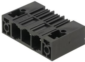
単列、高電流オス型ヘッダーは電極を犠牲にすることなく整列状態に取り付けることができます。また、ツール不使用でスパやくロックするための特許取得済みのフランジが付属します。接合プロファイルにより、固有に識別可能なコーディング多様性およびフランジへの追加締め付けにより、誤接を防止し、接続性と動作信頼性が最大限に向上します。3.5mm 長のピンは、フローはんだ付けに対して最適化され、プラグイン方向は、はんだ付けピンに対して 90° です。
