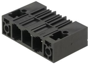
単列、高電流オス型ヘッダーは電極を犠牲にすることなく整列状態に取り付けることができます。また、ツール不使用でスピーディーにロックするための特許取得済みのフランジが付属します。接合プロファイルにより、固有に識別可能なコーディング多様性およびフランジへの追加締め付けにより、誤接を防止し、接続性と動作信頼性が最大限に向かいます。3.5mm 長のピンは、フローはんだ付けに対して最適化され、プラグイン方向は、はんだ付けピンに対して 90° です。
