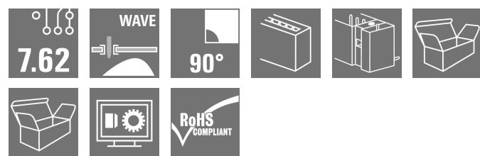
IEC 61800-5-1 準拠の 400 V IT パワーネットワーク対応、7.62 ピッチのはんだ付けフランジファスナー付属 90° オス型ヘッダー。
