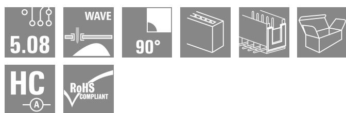
ガラスファイバー強化プラスチック製のピンヘッダーで、電線出口が90°になっており、フローはんだ付けに最適です。フランジバリエーション (F) は、各カウンターパーツ(コネクタ)や回路基板にネジ止めすることができます。はんだフランジ (LF) バージョンを使用すれば基板への補助固定にネジ作業を必要としません。また、機械的な歪みからはんだ付け箇所を保護することもできます。すべてのピンヘッダは、マニュアルでコーディングすることも、コーディング済みのものをご注文いただくことも可能です。HC = 高電流。
