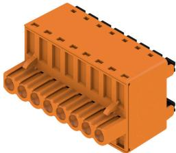
高性能バスアプリケーション用の強力なデイジーチェーンソリューションは、18.5Aの電流容量で400Vの補助電源供給にも適しています。大きなクランプ容量(最大2.5mmの導体断面積)は、低電圧降下のため、長いバスケーブルや高電流に特に有効です。
